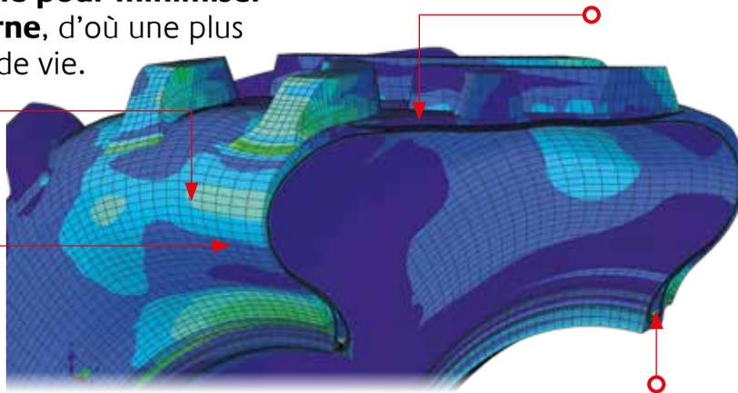
**Résistance supérieure de la carcasse** grâce à sa bande de roulement premium à 6 plis
