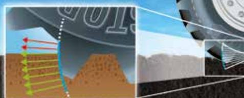
Le dessin « Involute » breveté des barrettes et l'empreinte plus large maximisent la traction et minimisent les pertes d'énergie
